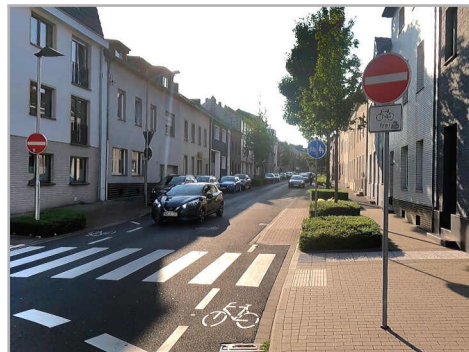
Abb. 42: Links Führung extrem: von unsichtbar hinter parkenden Autos ohne Schutz auf die Fahrbahn
