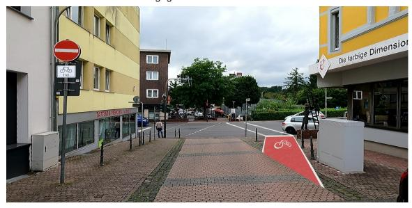
2. Der gesamte Kreuzungsbereich wird als Überweg für Radfahrende und zu Fuß gehenden markiert (Bild unten). Oder es wird für die neue roten Bereich der Alsdorfer Straße eine Furt auf die andere Straßenseite markiert (Bild oben). Außerdem werden die Streuscheiben der Ampeln getauscht, sodass diese auch für den Radverkehr gelten.
