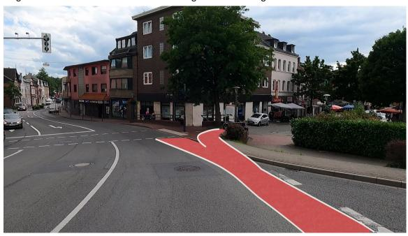
6. In beiden Richtungen wird auf der Geilenkirchener Straße eine abgetrennte Fahrradspur gebaut, insbesondere im unteren Bereich, wo Radfahrenden regelmäßig mit viel zu geringem Abstand überholt werden. Als Beispiel dafür kann der Pontwall in Aachen dienen. Die Rechtsabbiegerspur entfällt dabei, da sie ohnehin nur einen geringen Nutzen hat und hauptsächlich den Schleichverkehr durch Bicheroux- und Bahnhofstraße unterstützt.
