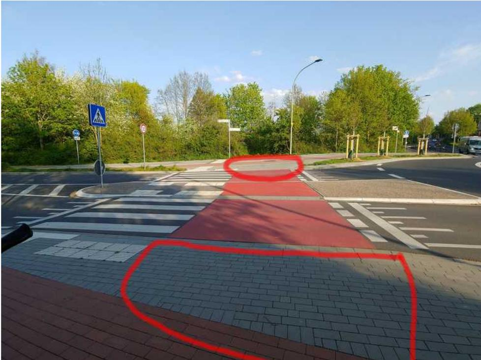
1.3: Die Benutzungspflicht des Radwegs in Richtung Herzogenrath soll aufgehoben werden. Dies wurde bei einem Ortstermin mit Herrn Reinartz vor etwa 2 Jahren so angekündigt. Trotzdem wurde er rot gepflastert und mit Schild versehen. Hier wäre eine saubere Führung auf die Fahrbahn sinnvoller gewesen, wie von uns bereits vorgeschlagen wurde.
